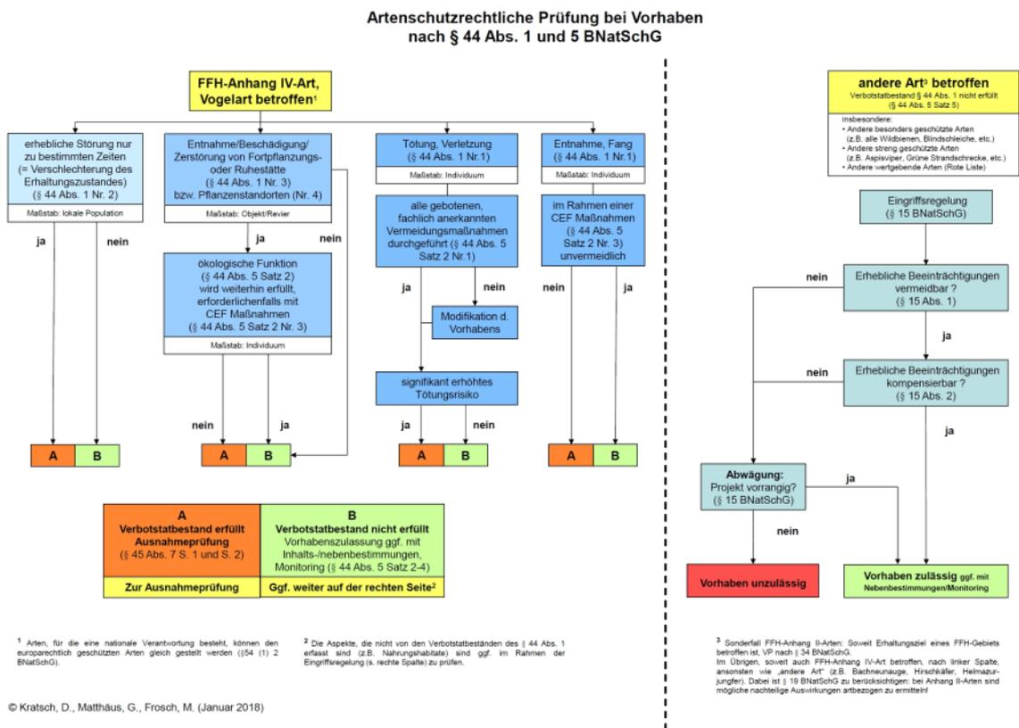
**Abbildung 3** Ablaufschema einer artenschutzrechtlichen Prüfung (Kratsch et al. 2018)
